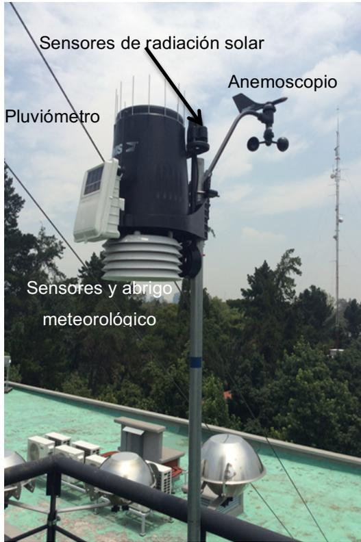
Figura 1: Estación meteorológica
